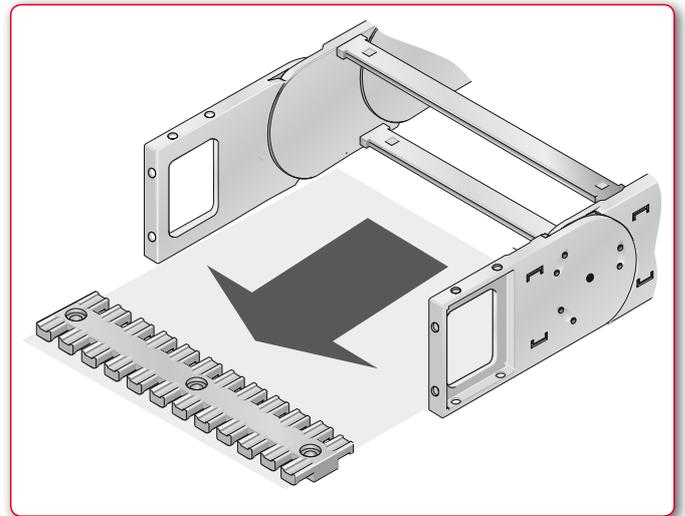
Para aumentar la distancia entre la sujeción hasta el primer punto móvil, es posible colocar ésta fuera del enlace de cadena. Para ello pueden usarse nuestras abrazaderas Steel Fix y perfiles sujetacables ZL-C, que se montan sobre carriles C. Los perfiles sujetacables ZL pueden fijarse también directamente a una superficie de carga, sin carril C.
