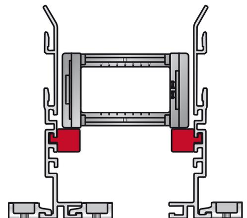
*Sección B-B: la cadena portacables se desliza sobre el perfil de carril de deslizamiento.*
