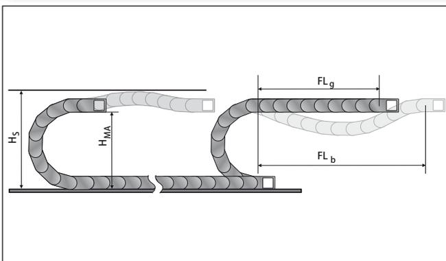
El vano es la distancia entre la conexión de la cadena en el adaptador y el inicio del arco de la cadena.
