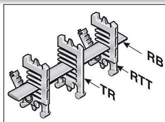
Para crear un sistema de estantería es necesario unir la balda con dos soportes de estantería (RTT) como mínimo. Si se utilizan más niveles/pisos, se evitará que los cables queden los unos sobre los otros, rocen demasiado entre sí y resulten dañados. Un montaje previo es innecesario, ya que el sistema de estantería se monta junto con sus cables rápida y fácilmente in situ.
