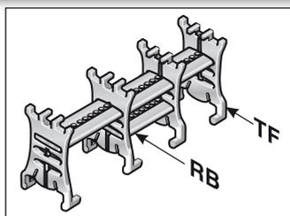
Para crear un sistema de estantería es necesario unir la balda con dos separadores como mínimo. Si se utilizan más niveles/pisos, se evitará que los cables queden los unos sobre los otros, rocen demasiado entre sí y resulten dañados. Las baldas están adaptadas a las anchuras de las cadenas.
