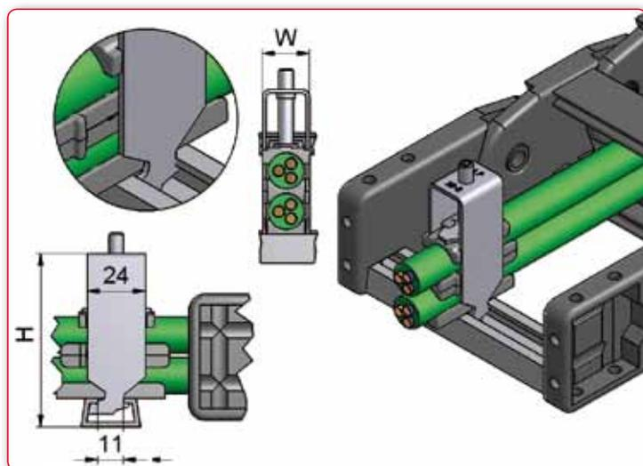
Carril C (con barnizado catódico por inmersión, ref. 81661610) que puede integrarse de forma fija para alojar las abrazaderas omega Steel Fix en los enlaces de la cadena.
