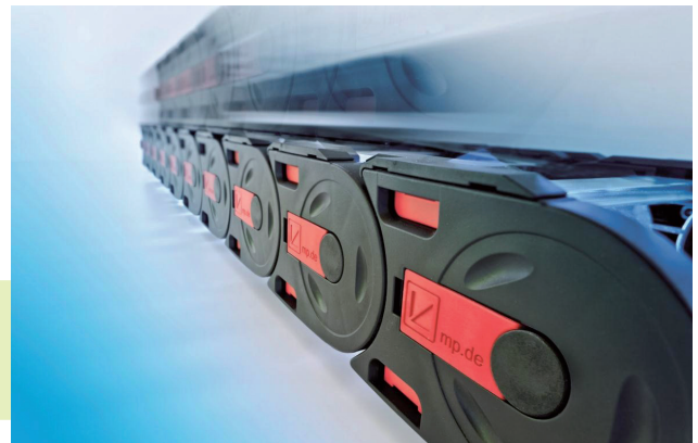
Fig. 1: Ya no son los eslabones los que realizan el deslizamiento, es decir, la parte superior y la inferior de la cadena directamente entre ellas, sino que se encargan de ello los carriles.
